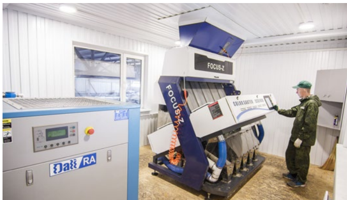
Введена в эксплуатацию вторая линия очистки семян с использованием оптического сортировщика, который позволяет добиваться 99,9% чистоты продукта.
