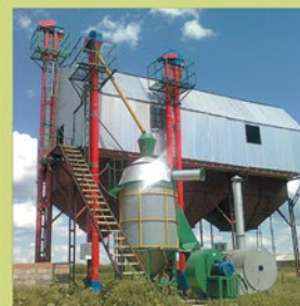
СУШИЛКА МОБИЛЬНАЯ СЕМЕННАЯ СМС-8 (со встроенным охладителем)
